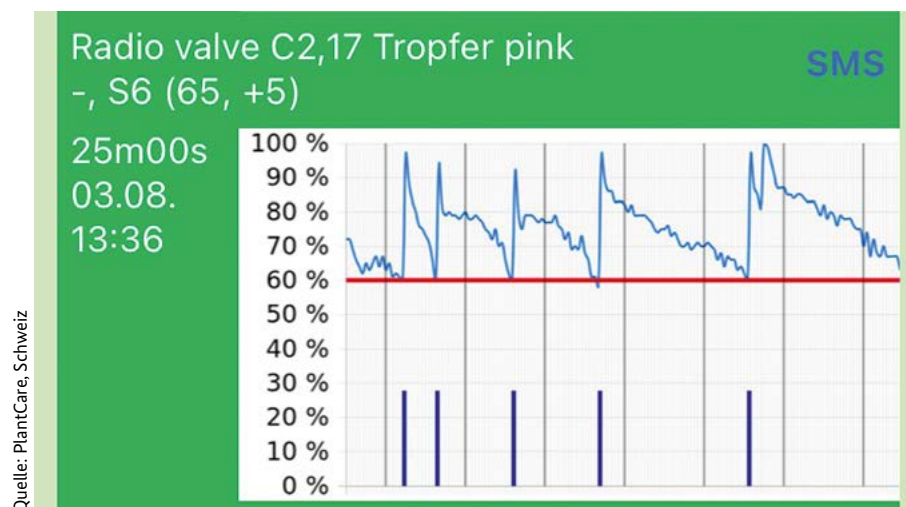
Auf der Bewässerungs-App zu sehen: Verlauf der Feuchtigkeit (blaue Kurve), der eingestellte Grenzwert (rote Linie) und die erfolgten Bewässerungen (senkrechte blaue Linien)
